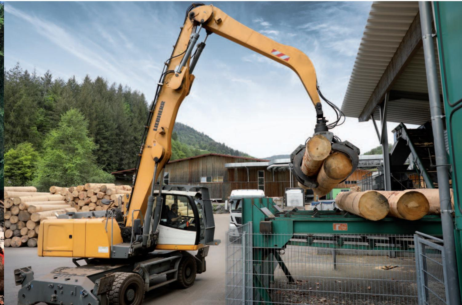
Der entrindete Stamm wird vom Bagger entnommen und auf dem Rundholzplatz zwischengelagert.
