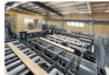
Die von der Bandsäge geschnittenen Hölzer laufen per Querförderer Richtung Nachschnittanlage.
