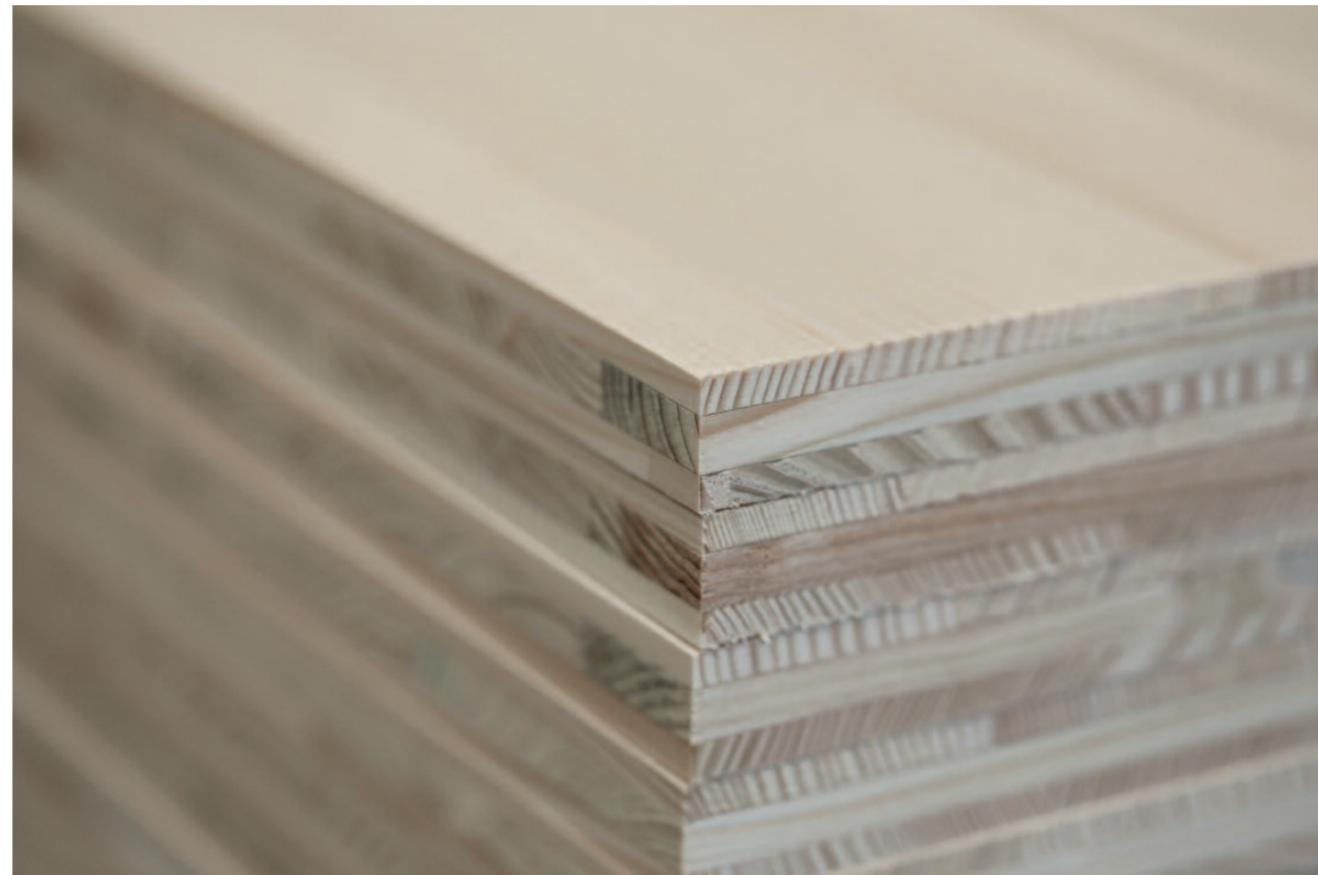
Für mehr Formstabilität: die Mittellagen der Dreischichtplatten werden quer zur Deck- und Rücklage eingelegt und verleimt.
