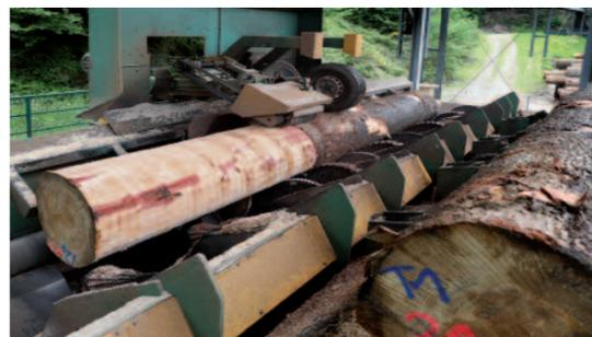
Dort wird das Rundholz komplett entrindet. Anschließend werden die entrindeten Stämme auf einem separaten Rundholzplatz sortiert und gelagert oder nach Bedarf direkt auf die Blockbandsäge-Aufnahme gelegt.
