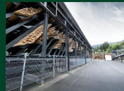
Insgesamt verfügen wir über 46 dieser Sortierboxen. Ist eine dieser Boxen voll, wird sie automatisch entleert. Die Schnittware wird hier nochmals visuell von einem Mitarbeiter kontrolliert, ehe die Stapelung erfolgt.
