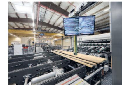
Nach kurzer visueller Kontrolle läuft das Schnittholz durch den "Opti-Trim" in die Sortierboxen.
