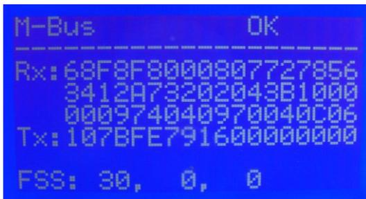
Wie bei COM A werden hier auch die Rx und Tx Signale dargestellt, wobei Tx hier die Frage vom Regler zum Zähler und Rx die Antwort vom Zähler zum Regler darstellt.
