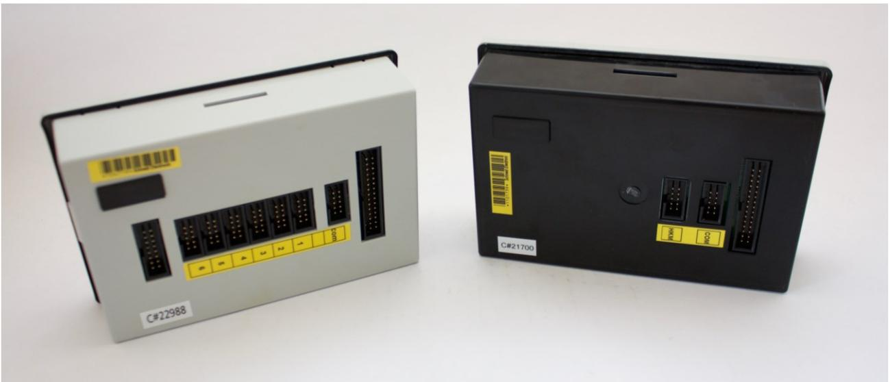
An den auf der Rückseite befindlichen Ports können sämtliche bei „**3.2 Komponenten mit Flachbandkabelverbindung zum Bedienteil**“ angeführte Komponenten angeschlossen werden. Das Bedienteil stellt die zentrale Rechen- und Bedieneinheit dar, ist daher zwingend für die Funktion notwendig.
