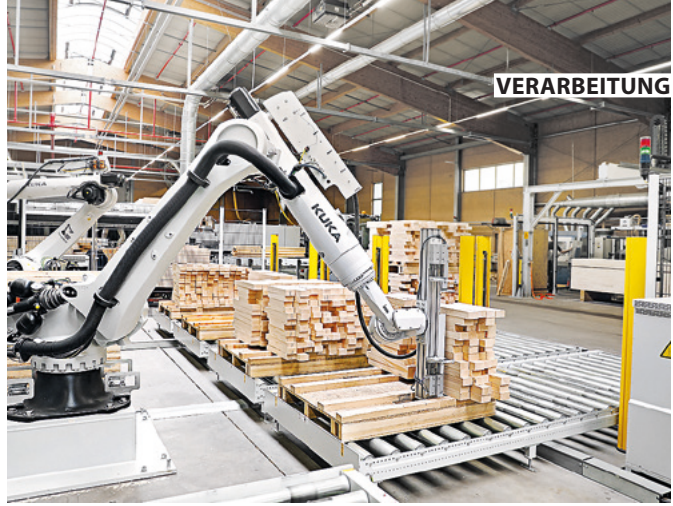
In der Weiterverarbeitung setzt man ebenfalls auf hohe Automatisierung – wie hier auf die Stapelung mithilfe von Robotern
