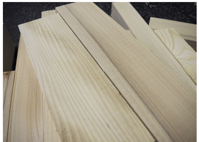
Bei gewissen Qualitäten unzulässig: Wimmerwuchs am linken Brett und Farbveränderungen (rechts)
