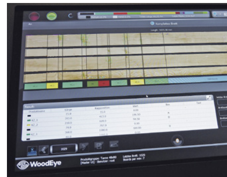
Ein Brett, viele Merkmale: Der neue WoodEye 6 bei Echtele erkennt Äste, Risse, Farbveränderungen und Strukturen bei Weißtanne zuverlässig
