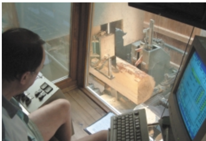
Eine Braun-Canali Bandsäge besorgt den Einschnitt des hochwertigen Rundholzes, gut einsehbar vom Kontrollstand aus
